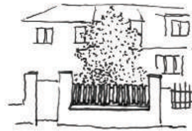
Mur bahut : semi-transparence et émergence du jardin au-dessus de la clôture
